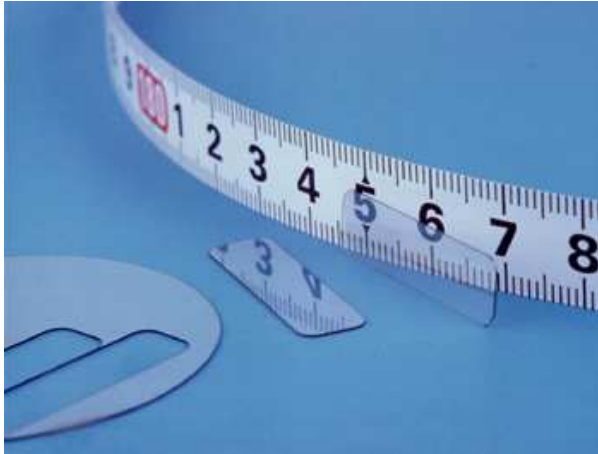
Ventanas transparentes de diamante para láseres de IR de alta potencia, o dispositivos de microondas. Especiales para ambientes agresivos
