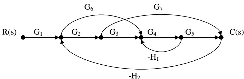
Obtener la función de transferencia  $C(s)/R(s)$  utilizando la fórmula de Mason.
