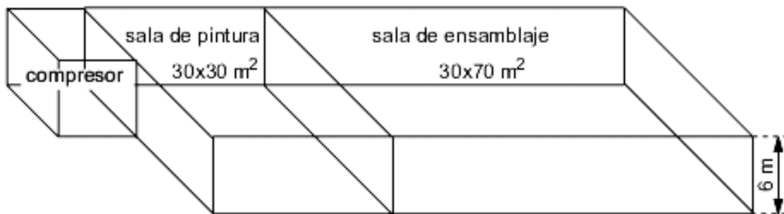
Fig 1.: Dimensiones de las salas y disposición de compresor
