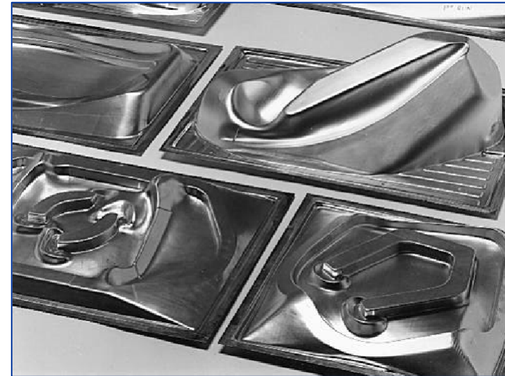
Distintas piezas de aluminio fabricadas mediante deformación superplástica ( \Rightarrow empleando aire a presión para estirar una chapa metálica sobre una preforma metálica)
