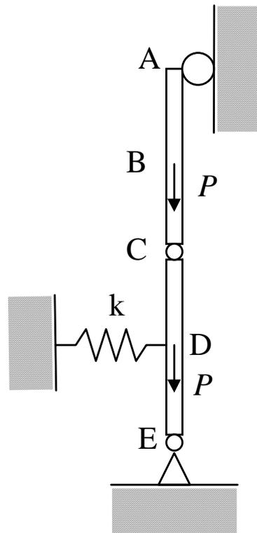
Demos un desplazamiento horizontal, de valor  $\delta$ , al punto C. La posición final del sistema será:
