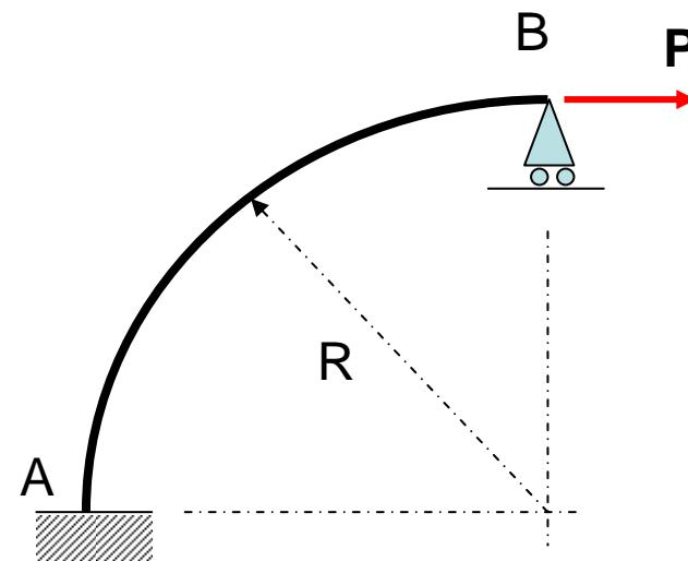
Sustituimos el apoyo en B por la reacción vertical F y obtenemos el momento flector en una sección genérica definida por el ángulo  $\theta$
