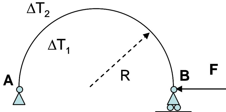
NOTA: Despréciense las deformaciones inducidas en las rebanadas del arco por los esfuerzos axil y cortante
