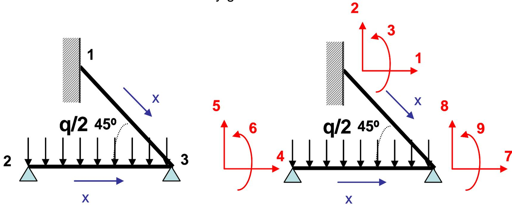
Cargas en nudos debido a reacciones en apoyos y empotramiento:
