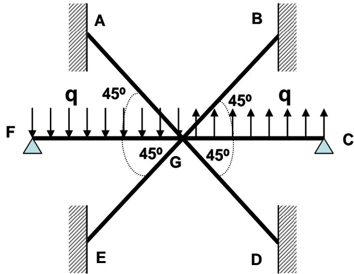
La estructura tiene dos ejes de antimetría que pasan por **G**: un vertical y otro horizontal, por lo que la estructura simplificada (el nudo **G** sólo puede girar) es:
