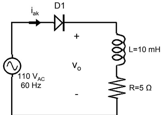
1. Represente la tensión ánodo-cátodo  $v_{ak1}$  en el diodo D1, la corriente ánodo-cátodo  $i_{ak1}$  y la tensión en la carga  $v_o$ .
