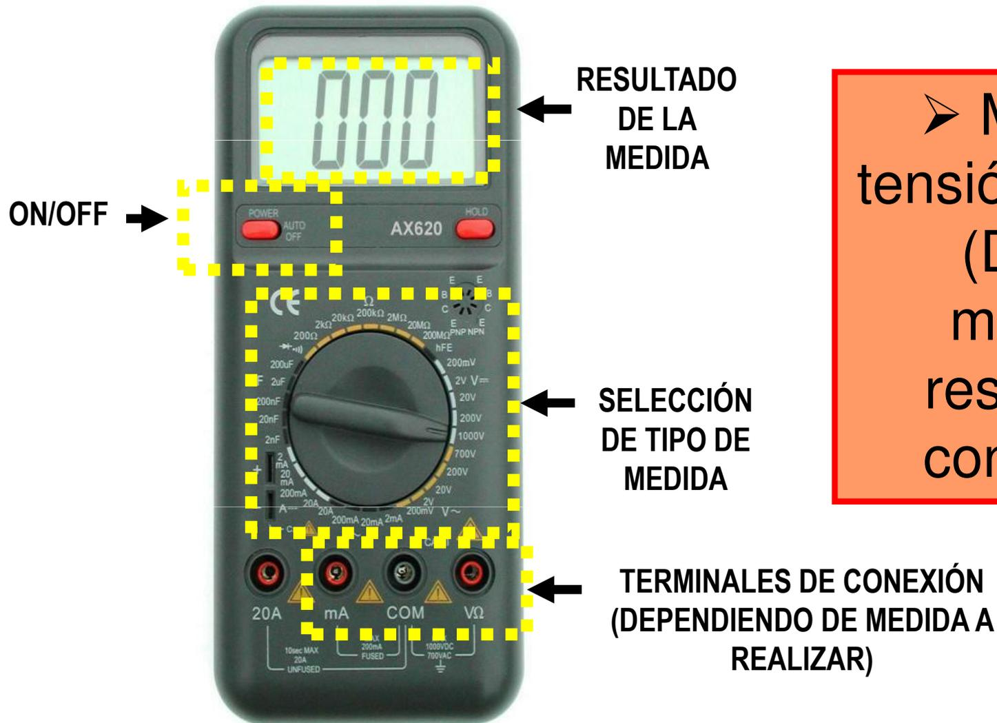
➤ Medidas de tensión y corriente (DC y AC), medidas de resistencias y continuidad...
