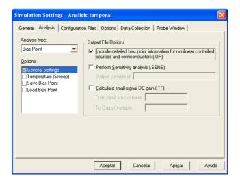
Si tenemos dispositivos semiconductores en el esquema, debemos marcar la opción **Include** detailed bias point information for nonlinear controlled sources and semiconductors (.OP). El resultado de esta simulación no es un fichero .dat, sino que se visualiza en un fichero de texto (extensión .out) que se abre desde la ventana de PSpice A/D con el menú **View** y la opción **Output File.**
