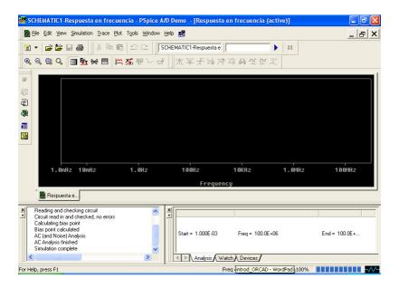
Para ver el valor de la tensión o corriente en cualquier punto del circuito en función de la frecuencia tenemos que seleccionar en el menú **Trace** la opción **Add Trace** y nos aparecerá la siguiente pantalla:
