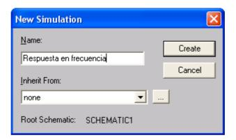
En esta pantalla debemos dar un nombre (Name) al nuevo perfil de simulación (*Respuesta en frecuencia* en el ejemplo). Tras nombrar el nuevo perfil de simulación y pulsar **Create** nos aparecerá la siguiente pantalla para indicar el tipo de simulación que queremos hacer (análisis en continua, análisis temporal, análisis en frecuencia...).
