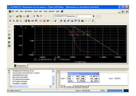
Para cambiar el cursor de una traza a otra basta con pinchar en el símbolo de la traza con el ratón pulsando el botón correspondiente al cursor que se quiere cambiar.
