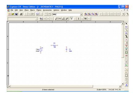
En este caso el valor por defecto de la fuente para simular el comportamiento en frecuencia del circuito es **1Vac** que no modificaremos.
