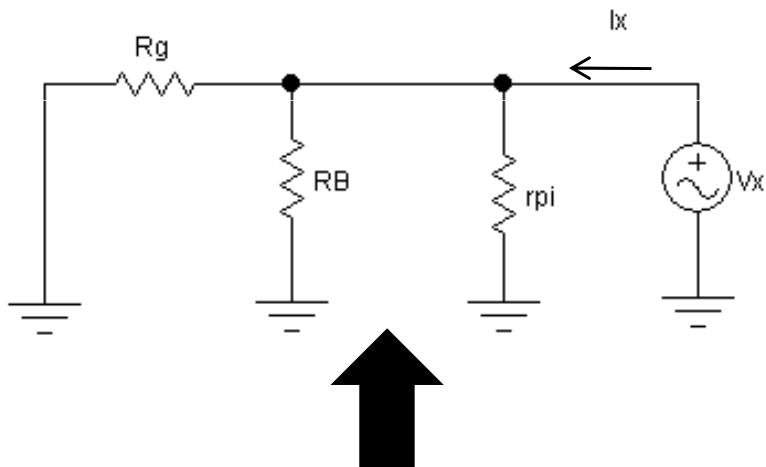
$$R_\mu^0 = R_B // r_\pi // R_g (1 + g_m R_C // R_L) + R_C // R_L$$
