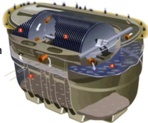
Conjunto de discos de plástico (1,5-3 m de diámetro) unidos axialmente por un eje en torno al cual rotan (1 - 4 rpm), parcialmente sumergidos en un tanque (más del 40% sumergido en el agua a tratar). Los discos están fabricados de material corugado sobre el que se adhiere el fango exponiéndose alternativamente al agua residual y al oxígeno del aire. En algunos casos se introducen elementos que favorezcan la agitación y el proceso de atrapar el aire.
