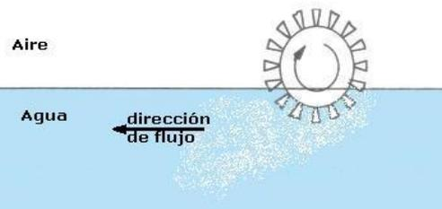
Los agitadores son sistemas mecánicos que mantienen el fango en suspensión gracias a la turbulencia que crean en la balsa del digestor. Pueden ser de eje vertical o de eje horizontal. El primer tipo es el más comúnmente empleado en reactores perfectamente agitados, mientras que el segundo se emplea, sobre todo, en los de flujo pistón.
