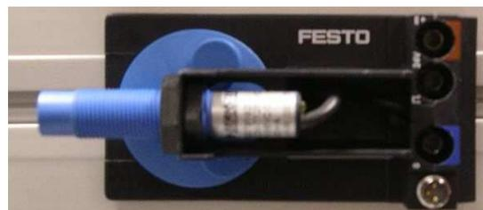
**Figura 6.-** Sensor capacitivo
