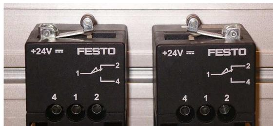
Figura 1.- Sensores electromecánicos
