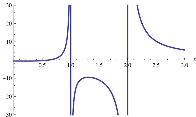
Figura 1.2: **Función racional.** Gráfica de  $f(x) = (x^3 + 2x^2 - 1)/(x^3 - 2x^2 - x + 2)$ . En los puntos en los que se anula el denominador la función no está definida; el resto de puntos pertenecen al dominio y en todos ellos la gráfica de la función viene descrita por una curva suave.
