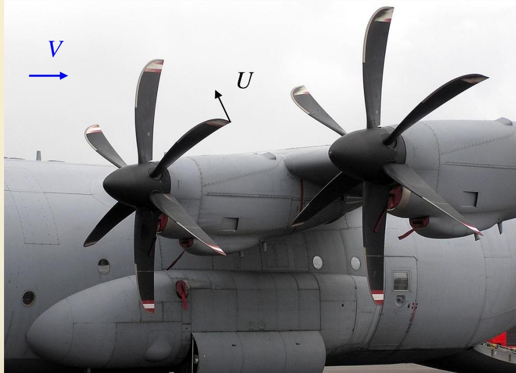
En ellas existe un conducto virtual que no es de forma fija, formado por la superficie divisoria entre el caudal que pasa por la turbomáquina y el exterior. Solamente el que pasa a través de ella sufre su acción. Dan menos rendimiento al carecer de estator y además, al ser abiertas existen fugas de intradós a extradós en la punta de los álabes (véase la siguiente transparencia).
