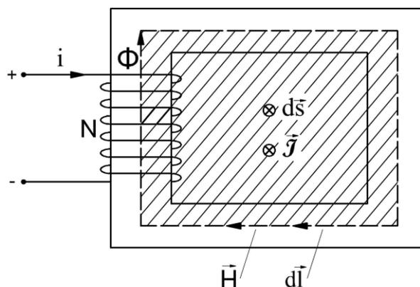
Figura 1.11: Circuito magnético simple
