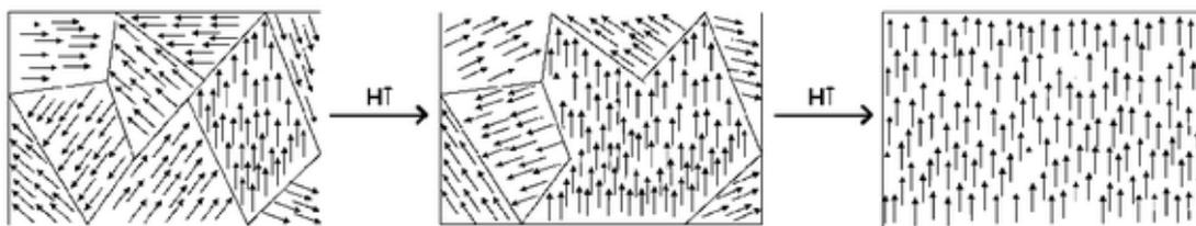
Figura 1.13: Dominios magnéticos en un material ferromagnético
