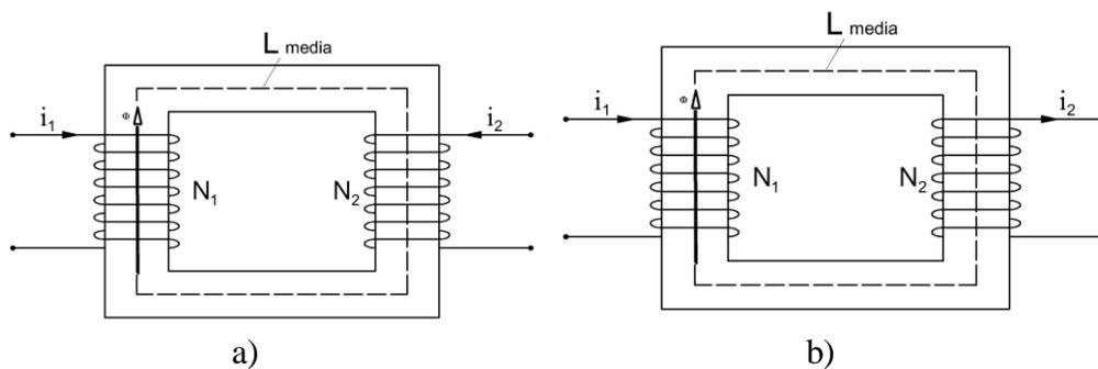
Figura 1.12: circuito magnético con dos bobinas
