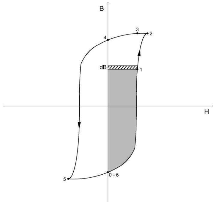
Figura 1.19: Almacenamiento de energía eléctrica en el campo magnético
