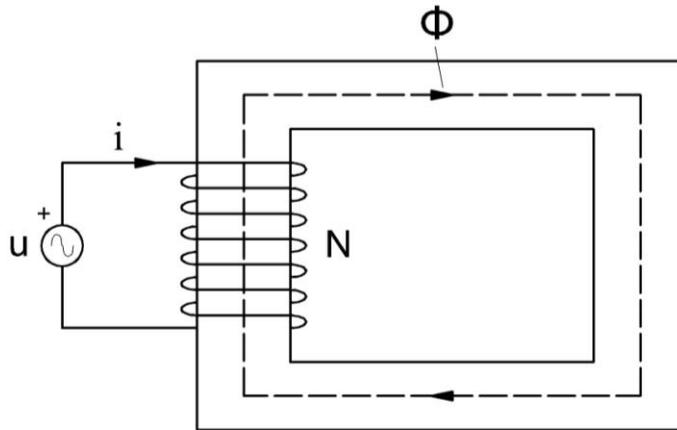
Figura 1.17: Circuito magnético excitado mediante corriente alterna
