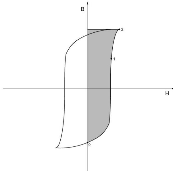
Figura 1.20: Máxima energía almacenada en el campo magnético
