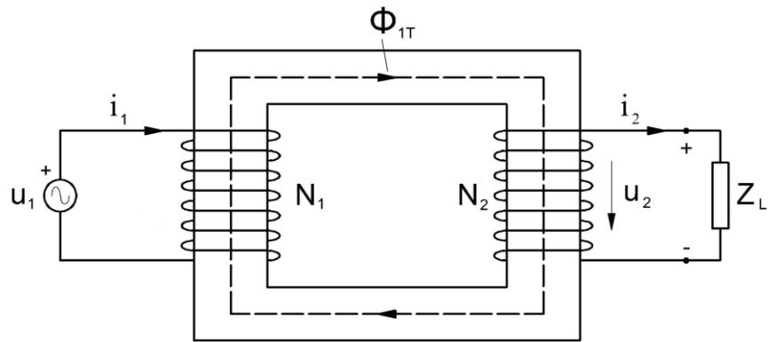
Figura 1.23: Transformador alimentando una carga
