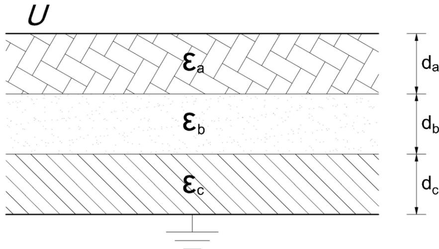
Figura 1.1: Reparto del campo eléctrico entre varios dieléctricos
