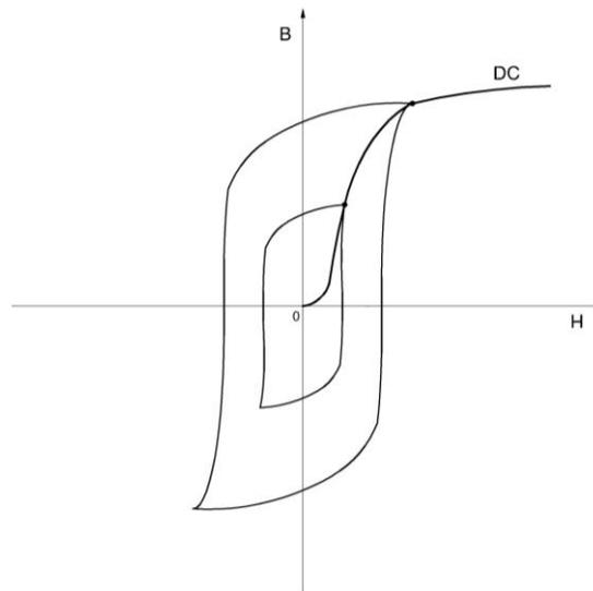
Figura 1.16: Curvas de magnetización en corriente alterna
