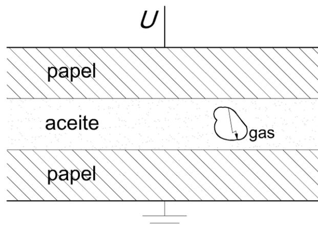
Figura 1.2 Generación de una descarga parcial en un equipo eléctrico
