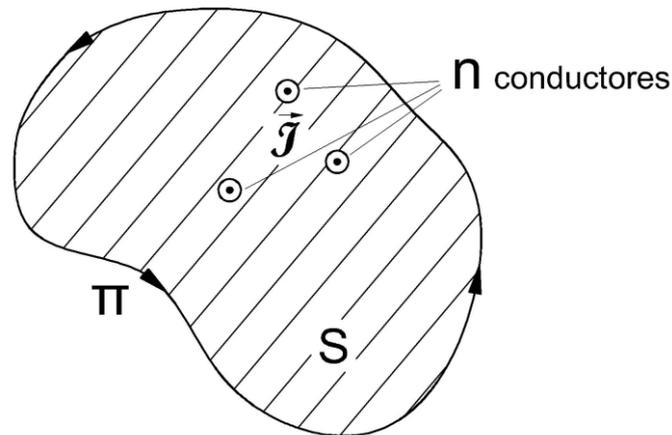
Figura 1.9: Superficie para la integración de la cuarta ley de Maxwell
