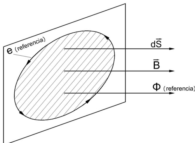
Figura 1.6: Superficie de integración de la segunda ley de Maxwell y línea que la contornea. Referencias de flujo y fuerza electromotriz.
