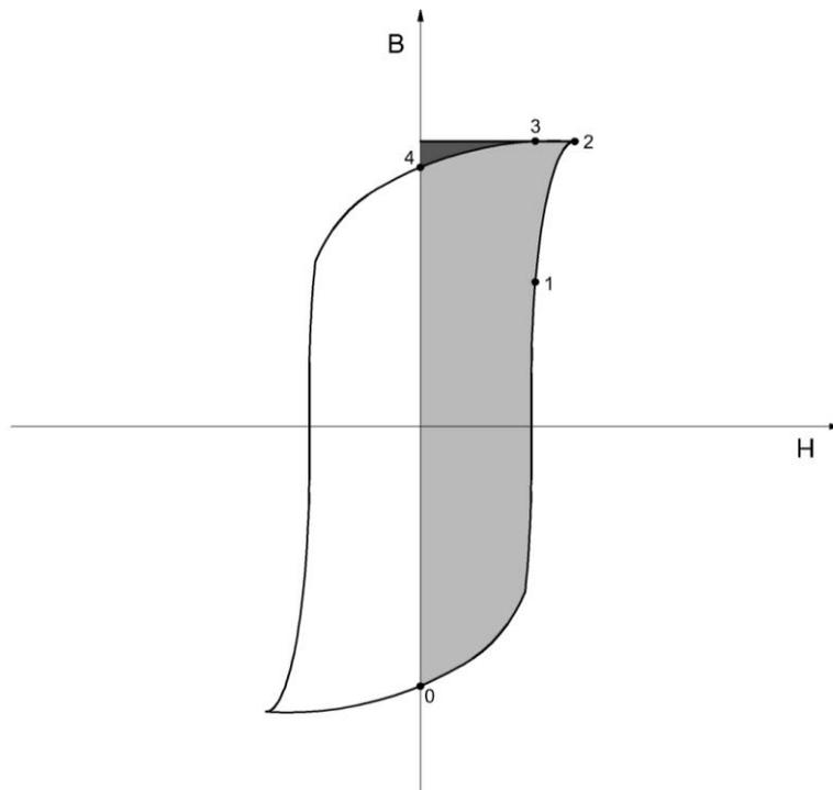
Figura 1.21: Devolución de energía a la red al desmagnetizar el núcleo
