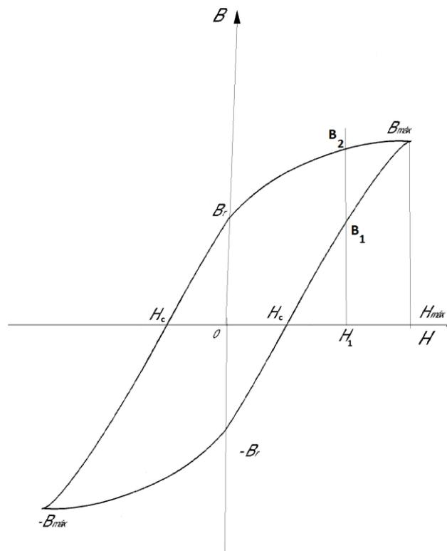
Figura 1.14: curva de magnetización de un material magnético
