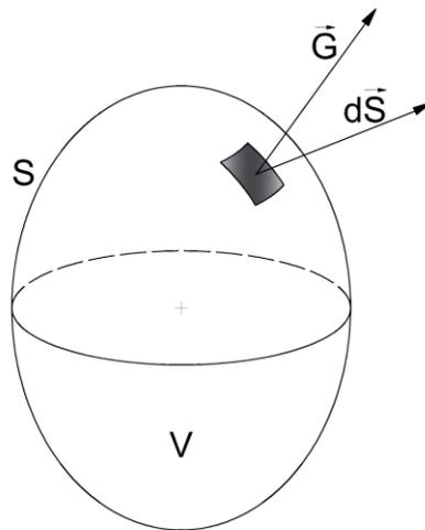
Figura 1.3: Volumen al que se aplica el teorema de Gauss y superficie que lo encierra
