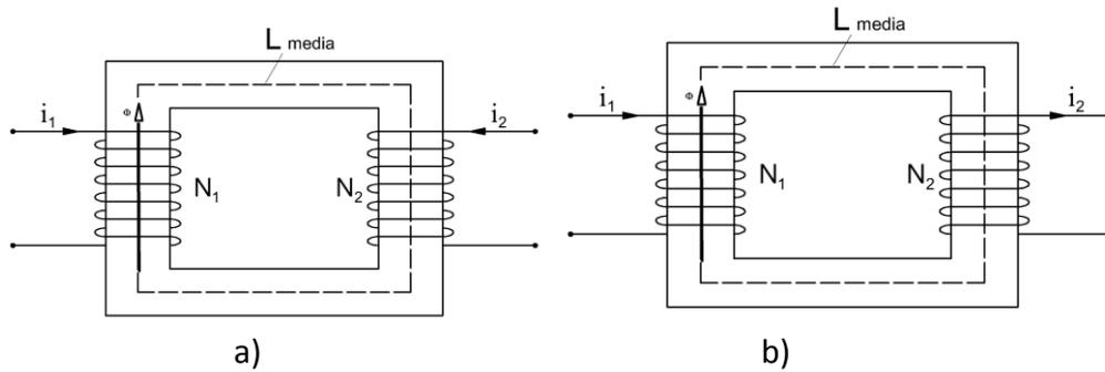
Figura 1.22: circuito magnético con dos bobinas
