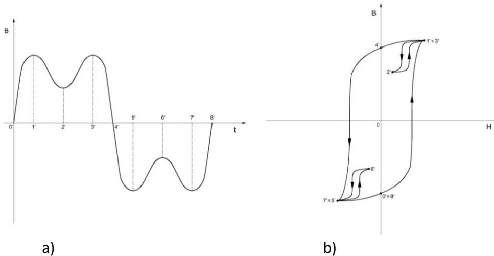
Figura 1.15: Onda de inducción con armónicos y ciclo de histéresis correspondiente
