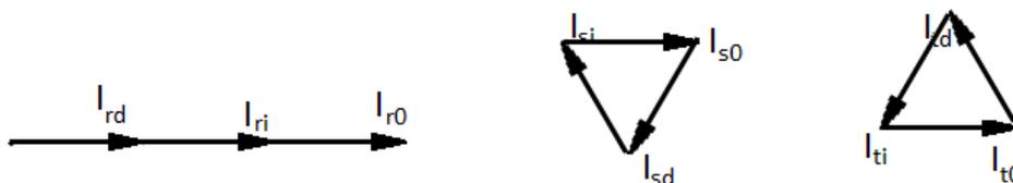
La obtención de las corrientes en el primario que corresponden a cada una de las componentes de la corriente secundaria se muestra en el apartado 4.6.1 del Tema 4. Una vez se tengan las componentes de secuencia de las corrientes primarias se sumarán para obtener las corrientes en el primario.
