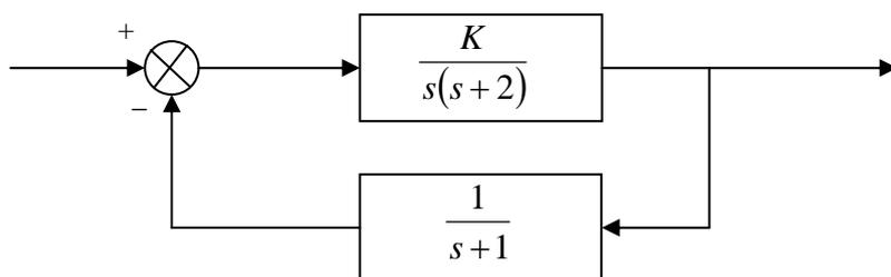
Obtener analíticamente el valor de la ganancia K para que el sistema tenga un margen de ganancia de 11 dB y calcular el correspondiente margen de fase.
