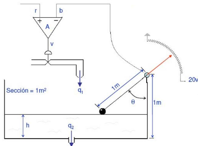
El sensor es un flotador de peso y dimensiones despreciables unido a una varilla de peso despreciable cuyo extremo es el cursor de un potenciómetro de  $\frac{1}{4}$  de circunferencia.
