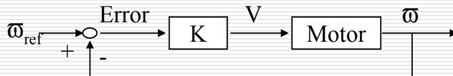
Tomando como salida la posición, un motor de CC es un sistema de tipo 1, por lo que  $e_p = 0$
