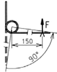
Una máquina para bobinar pequeños solenoides con hilo esmaltado de cobre de  $\varnothing 0,1$  mm dispone de un tensor formado por un resorte helicoidal y una polea de guía en su extremo libre, según la figura, para mantener la tracción del hilo entre valores adecuados y así evitar roturas de éste y defectos en el bobinado.
