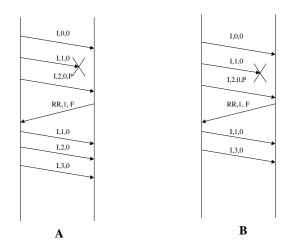
**P 3-21** Considere la figura adjunta en la cual el nodo A genera tramas con destino al nodo C a través del nodo B.
