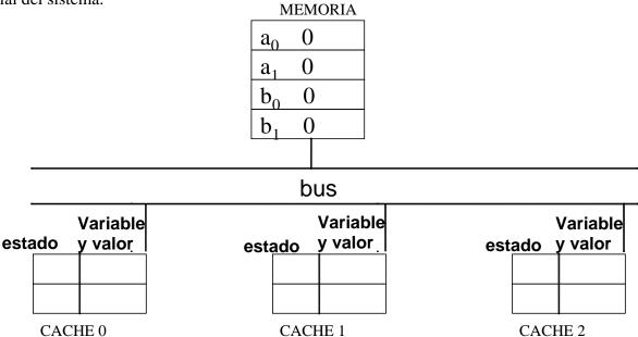
La coherencia de las memorias caché se lleva a cabo utilizando el protocolo *write-once*. A continuación se dan tres secuencias de acciones realizadas por los procesadores P<sub>0</sub>, P<sub>1</sub> y P<sub>2</sub>.
