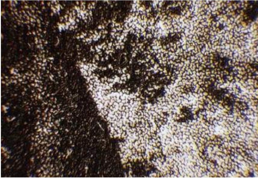
Vista al microscopio de la retícula del collotipo
