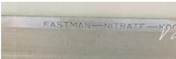
Identificación de nitrato de celulosa.
