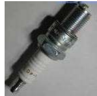
Fig. 1.12.- Esquema de una bujía y vistas de una bujía representativa.
