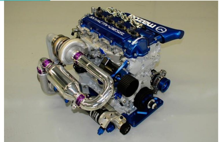
Fig. (3.III.9).- MEP Mazda Skyactive-G de inyección al cilindro Q = 2 l; r_e = 13 ; p_{iny} = 200 bar. Fuentes: Accedidas el 14/03/2014 http://www.mazdamexico.com.mx/mexico/skyactiv http://www.mazda.com/mazdaspirit/skyactiv/engine/skyactiv-g.html
