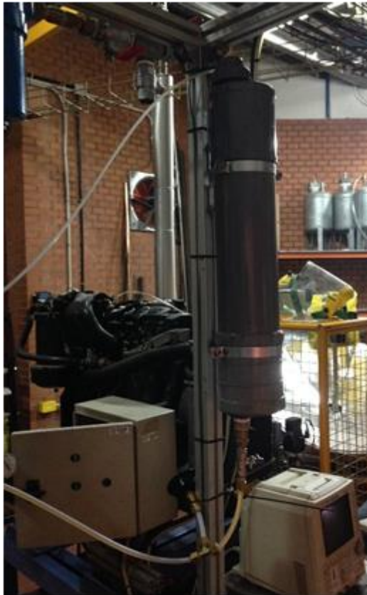
Fig. 5: Izquierda: depósito de presurización del aceite. Derecha: Unidad de regulación y limpieza del aire comprimido. Fuente: [1].
