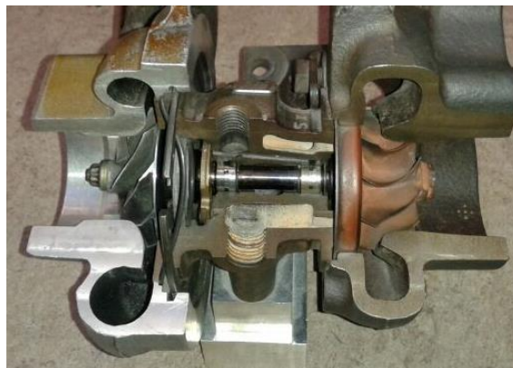
Fig. 1: Sección de un turbo sin álabes directrices (compresor: izq.; turbina: der.).
