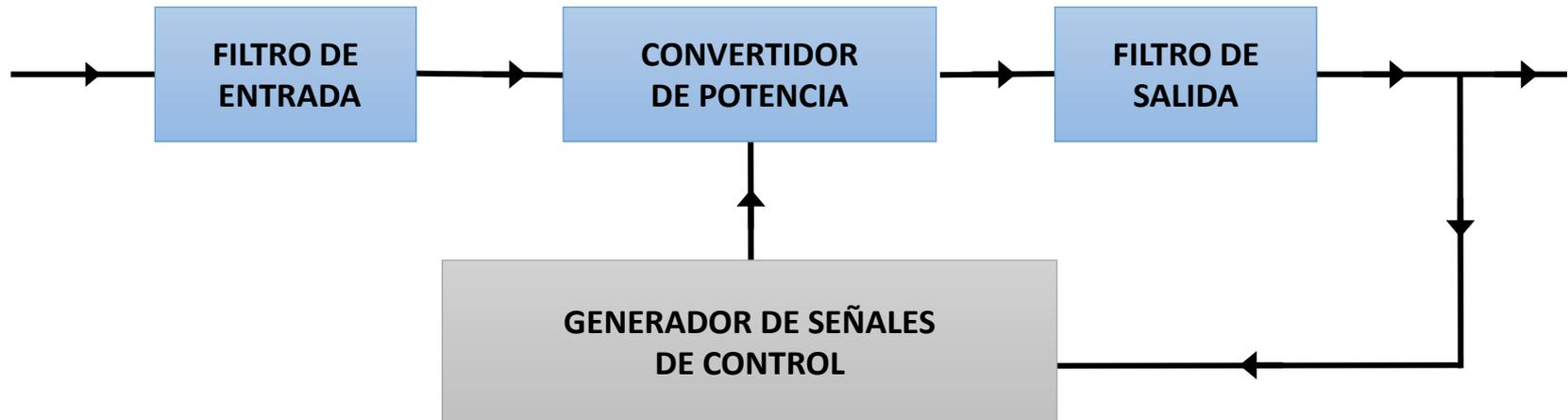
Genera los pulsos de control de los dispositivos electrónicos de potencia y cumplir con las especificaciones del convertidor en cuando a niveles de tensión, corriente, potencia, etc.
