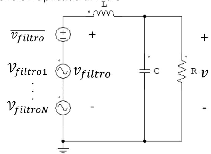
3. Se aplica superposición y se resuelve cada circuito (régimen sinusoidal permanente) a una frecuencia
