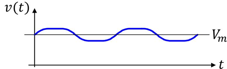
$v(t)$  puede aproximarse por un valor medio  $V_m$  más la suma de algunos armónicos residuales:  $V_1, V_2, V_3 \dots V_n$
