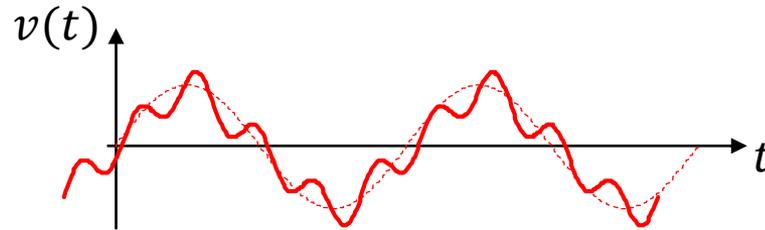
$v(t)$  puede aproximarse por la suma de un primer armónico  $V_1$  más algunos armónicos residuales:  $V_3, V_5 \dots V_n$
