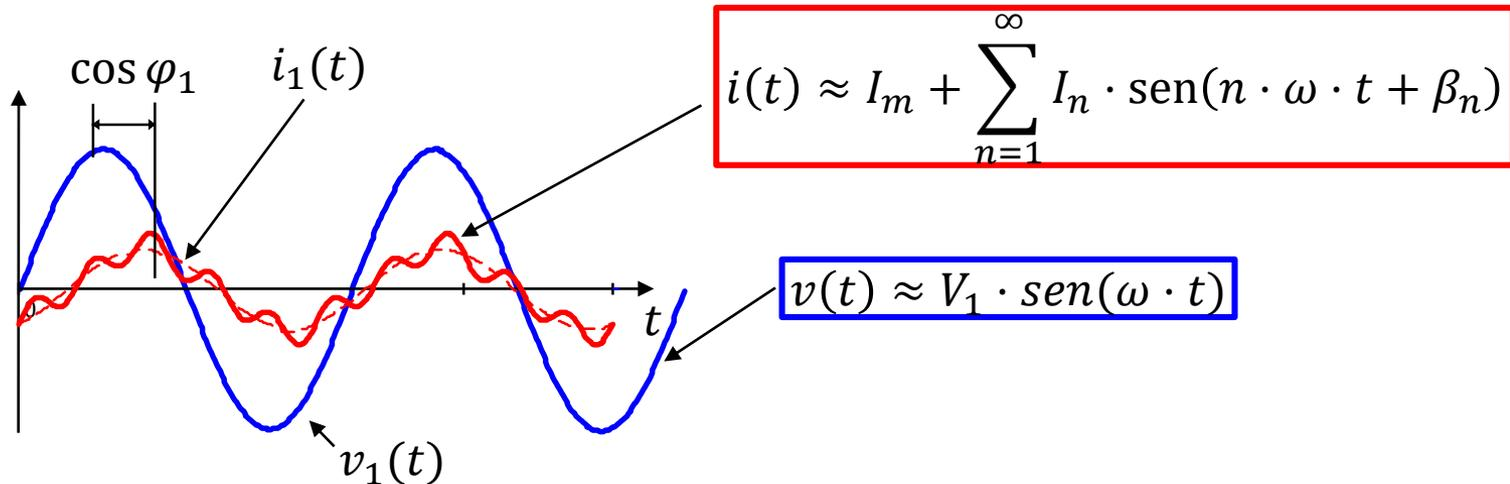
Puesto que la tensión  $v(t)$  es sinusoidal y solo tiene el primer armónico de tensión:
