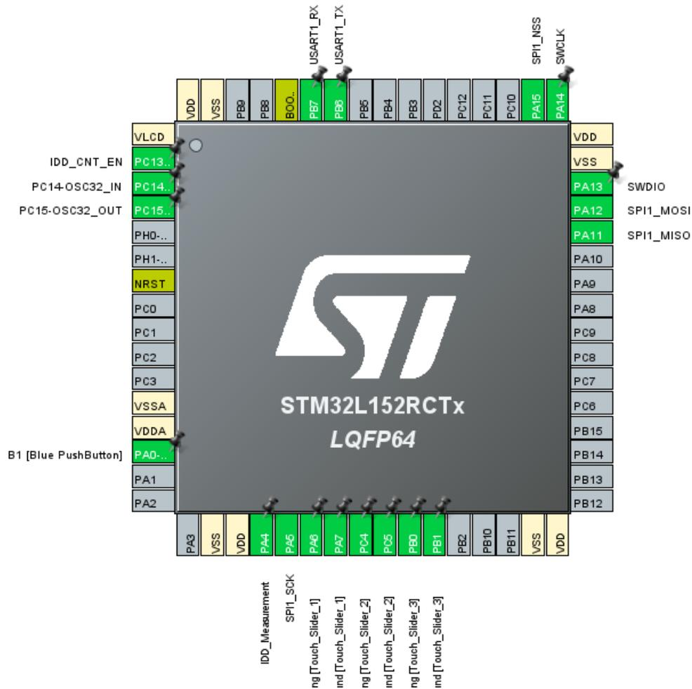
La configuración de la USART queda así (junto con la activación del USART1 global interrupt):
