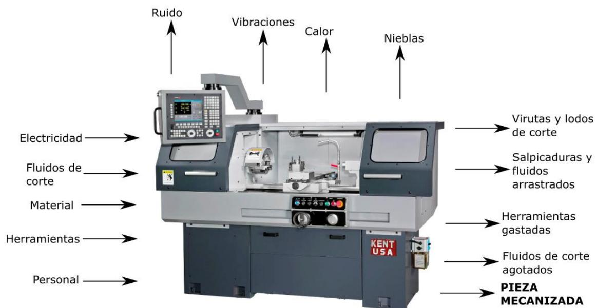
*Figura 6.1 Entradas y salidas en un proceso de mecanizado. Modificada de A. Pernía, Prácticas de mecanizado en torno y fresadora, 2018*
