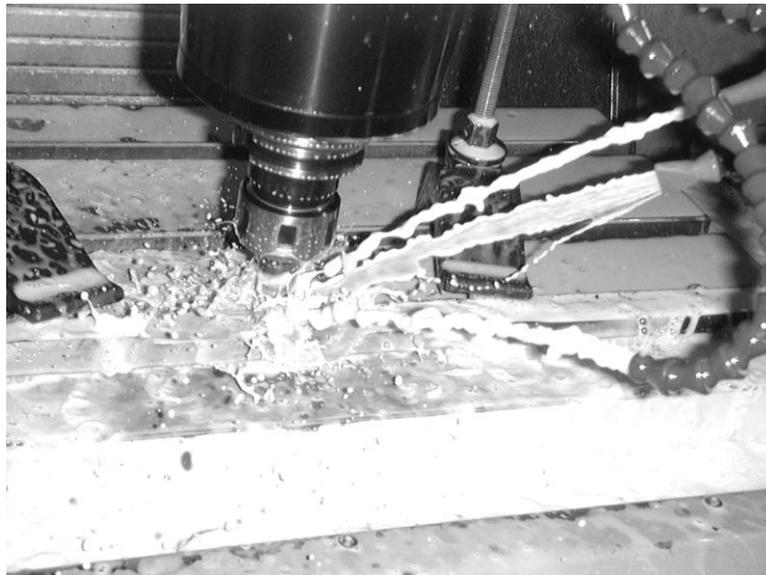
*Fig. 3.1 Utilización de fluido de corte en operaciones de mecanizado. Elaboración propia.*
