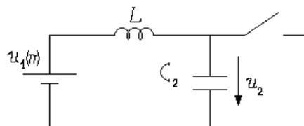
Figura 10.4. Conexión del segundo condensador en el circuito de la figura 10.1.
