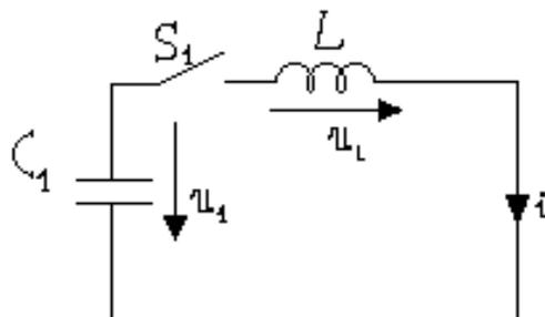
Figura 10.2. Circuito equivalente conexión primer condensador.
