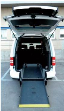
**Ilustración 3 Rampa de acceso a un automóvil**
