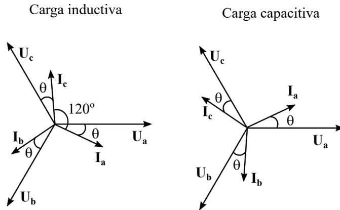
La corriente que fluye a través del neutro es la suma de  $\underline{I}_a$ ,  $\underline{I}_b$  y  $\underline{I}_c$ ; sin embargo, como las tres corrientes forman un sistema trifásico equilibrado (es decir, tienen la misma magnitud y un desfase relativo de  $120^\circ$ ), la corriente que circula por el neutro es cero:
