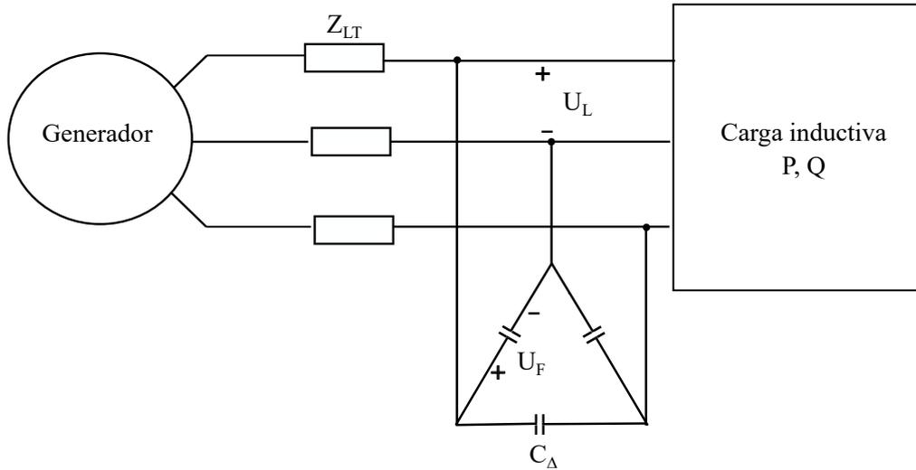
$$Q_{C\Delta} = -3 \cdot \omega \cdot C_{\Delta} \cdot \underbrace{U_F^2}_{U_L^2} = -3 \cdot \omega \cdot C_{\Delta} \cdot U_L^2 \quad (57)$$
