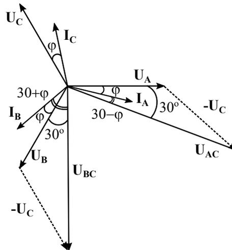
$$W_1 = U_L \cdot I_L \cdot \cos(\widehat{\underline{U}_{AC} \underline{I}_A}) = U_L \cdot I_L \cdot \cos(30 - \varphi) = U_L \cdot I_L \cdot \left( \frac{\sqrt{3}}{2} \cos \varphi + \frac{1}{2} \cdot \text{sen} \varphi \right) \quad (68)$$
