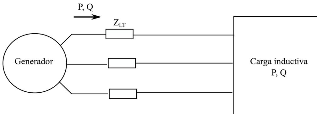
La solución que da la industria a este problema consiste en conectar bancos de condensadores en paralelo con las cargas inductivas; estos condensadores cederían parte de la potencia reactiva absorbida por las inductancias. En este caso el generador tan solo suministraría una parte la potencia reactiva demandada por la carga mientras que la mayor parte de la potencia reactiva requerida la entregarían los condensadores:
