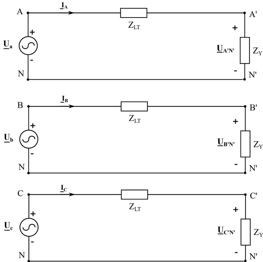
Además, como el sistema está equilibrado, las magnitudes eléctricas de las tres fases tienen la misma amplitud y un desfase conocido ( $120^\circ$ ). El comportamiento de todo el sistema podría derivarse del análisis del sistema monofásico que se muestra a continuación. Este es el llamado **equivalente monofásico** o **equivalente fase-neutro** del sistema.
