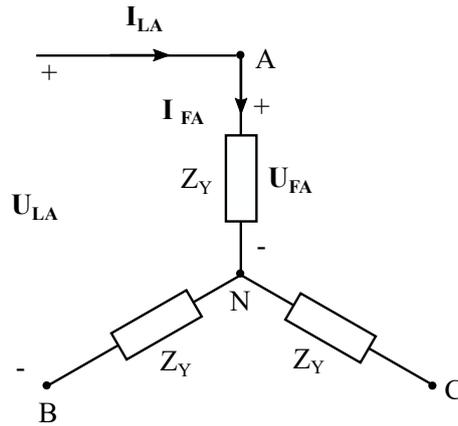
La potencia activa absorbida por la carga es la suma de la potencia activa absorbida por cada impedancia individual:
