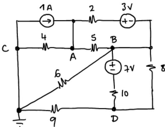
Calcular la corriente de cortocircuito entre A y B en función de las tensiones de los nodos.
