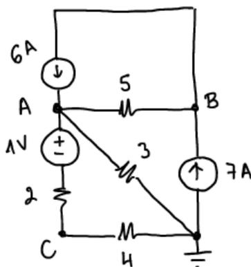
Calcular el equivalente de Thévenin entre los puntos B y C.
