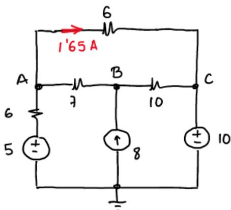
Calcular el equivalente de Thévenin entre los puntos B y C sabiendo que la corriente que circula de A a C por la resistencia de  $6\Omega$  vale  $1,65\text{A}$ .
