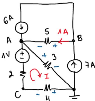
El circuito se puede resolver con 2 nodos o con una ecuación de malla.
