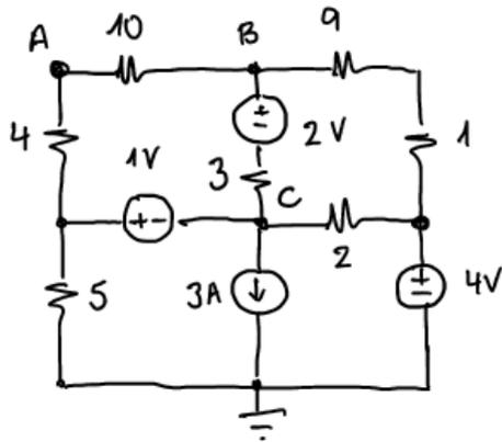
Calcular la resistencia equivalente entre los puntos A y B, es decir, la resistencia de Thévenin.
