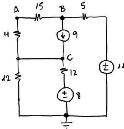
Calcular el equivalente de Thévenin entre A y B sabiendo que  $V_B = -18'67 \text{ V}$ .
