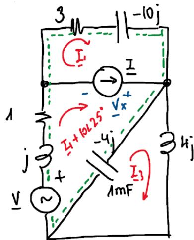
$$(3 - 10j)I_1 - 4j(I_1 + 10 < 25^\circ - I_3) - 5 < -30^\circ + (1 + j)(I_1 + 10 < 25^\circ) = 0$$
