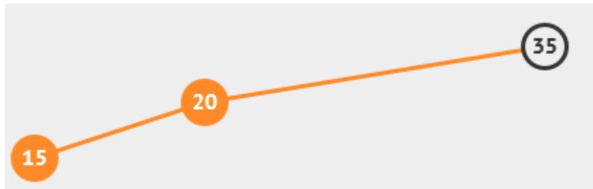
La segunda rotación a aplicar, ya la conocemos, es la rotación simple derecha, porque el nodo con el elemento 35 pasará a ser el subárbol derecho de la nueva raíz, el nodo con elemento 20. En el árbol resultante, ya están todos los nodos equilibrados.
