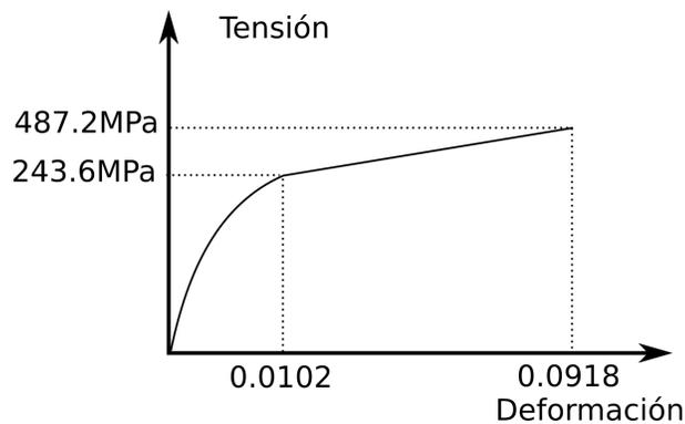
Figura 6: Tensión vs Deformación
