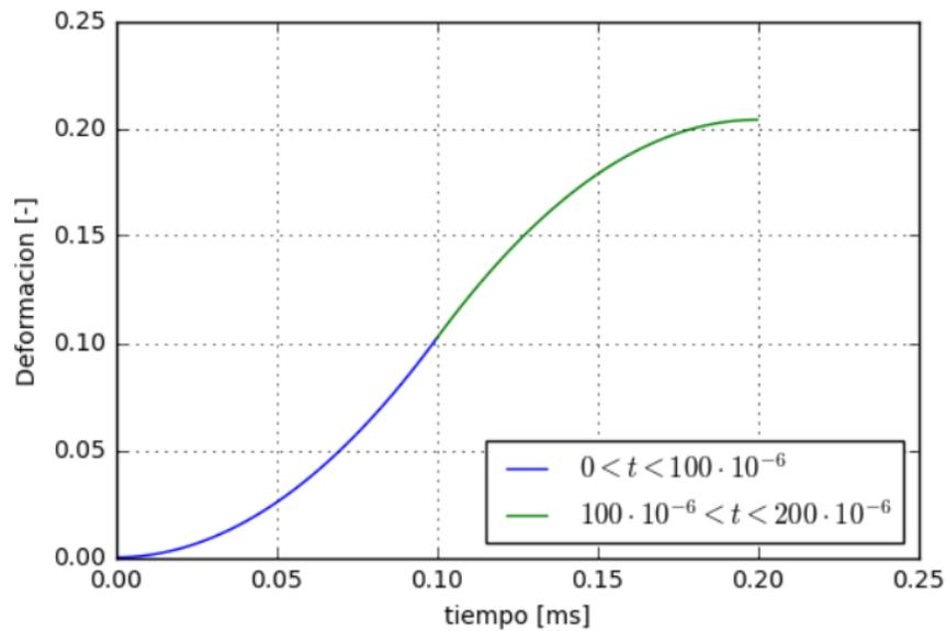
Figura 7: evolución de la deformación durante el ensayo
