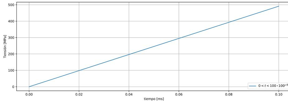
Para calcular la curva tensión deformación de la probeta debo despejar la tensión o la deformación del tiempo. Por lo que en el primer tramo  $0 < t < 10 \cdot 10^{-6}$ :
