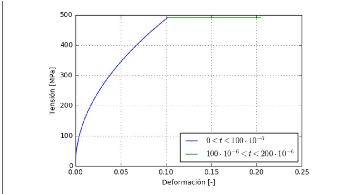
6. [ Puntos] En un ensayo de compresión en la barra Hopkinson asuma que la onda incidente es una onda cuadrada y que se cumple  $\varepsilon_i + \varepsilon_r = \varepsilon_t$ . Si la deformación reflejada es una onda de tracción lineal, con valor 0 al inicio y decreciente con el tiempo, como de manera razonada como debe ser la forma de la deformación transmitida en la barra transmisora, la curva de tensión-tiempo, la curva deformación-tiempo, y la curva constitutiva del material.
