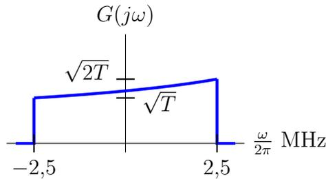
II) En este caso el ruido no es blanco, ya que réplicas de la respuesta en frecuencia de la función de ambigüedad del filtro receptor no suman una constante. Ahora, dado que  $f(t) = g(-t)$ ,  $R_f(j\omega) = |F(j\omega)|^2 = |G(j\omega)|^2$ , respuesta que se muestra en la siguiente figura.
