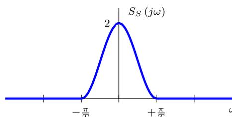
d)  $R_s = \frac{2B}{1+\alpha} = 6,4$  kbaudios, así que  $m = \frac{R_b}{R_s} = 3$  bits/símbolo y  $M = 2^m = 8$  símbolos.
