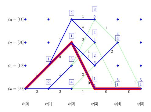
Ejercicio 5.10 (Solución) a) La representación esquemática y el diagrama de rejilla del código se muestran en la figura
