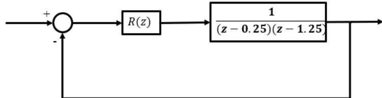
Calcular el regulador más simple posible, utilizando el método de diseño basado en el lugar de las raíces, que haga que el sistema realimentado tenga los polos dominantes en  $z_d = 0,25 \pm i0,25$ .
