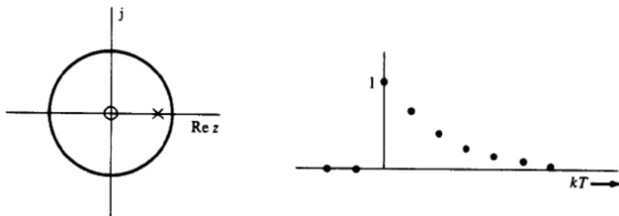
Figura 9: Posición de los polos, y la respuesta impulsional del sistema.
