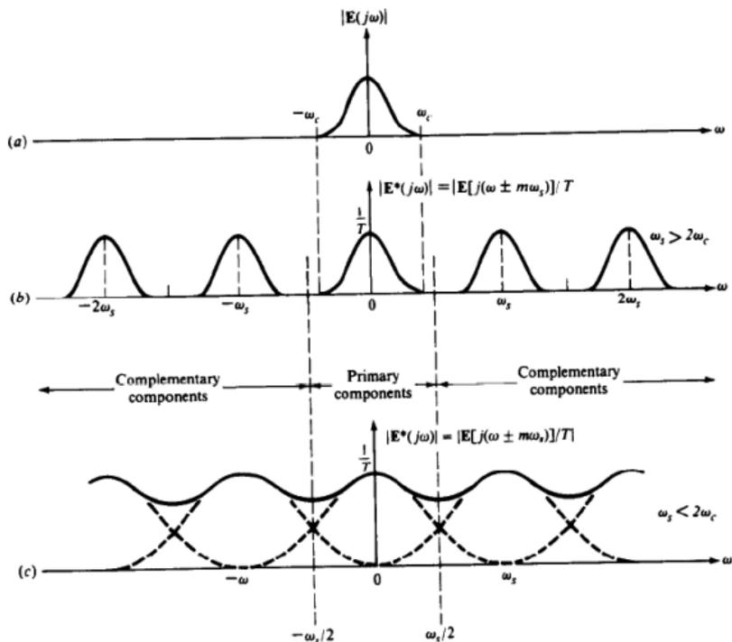
Figura 2: Transformadas de amplitud de Fourier.
