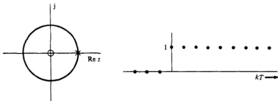
Figura 8: Posición de los polos, y la respuesta del sistema.
