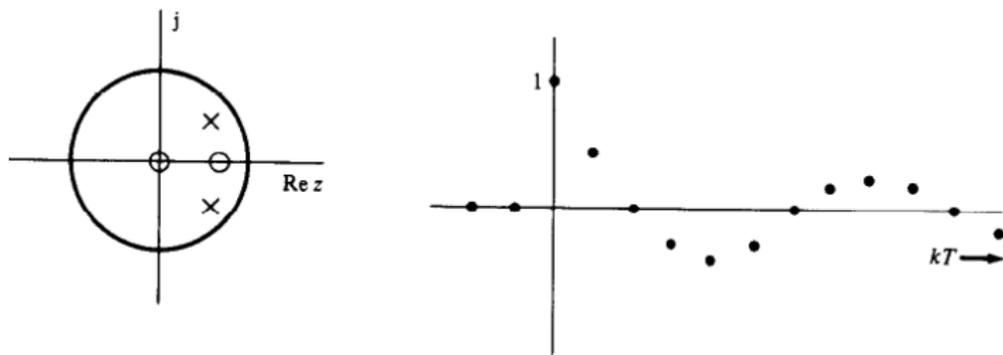
Figura 10: Posición de los polos, y la respuesta impulsional del sistema.
