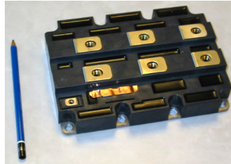
Figura 1: Un IGBT de 3300 V y 1200 A. Ver atribución en A
