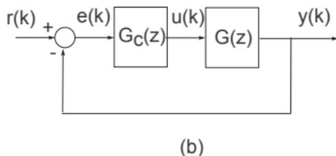
Figura 1: Estructura del control a) y equivalente discreto del sistema b).
