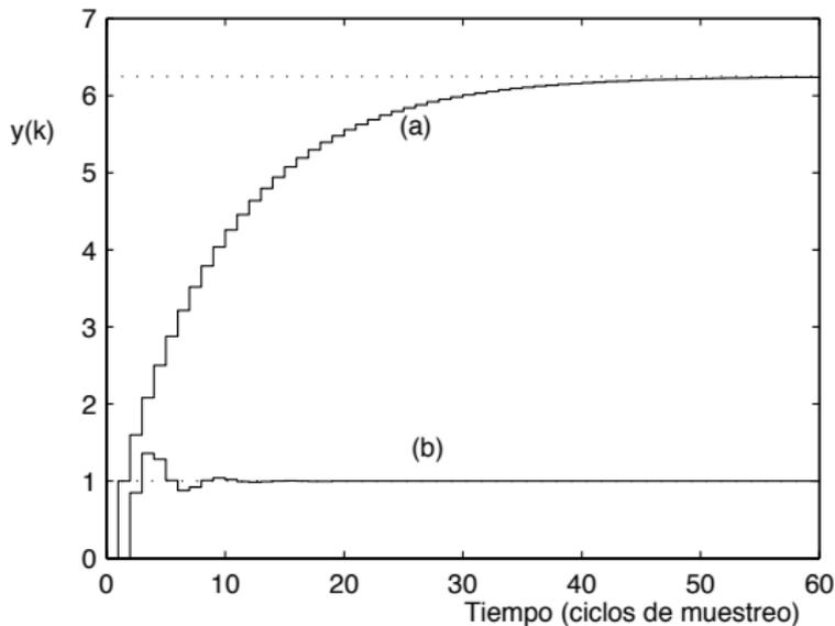
**Figura 2:** Respuesta del sistema a) en bucle abierto y b) en bucle cerrado con el controlador diseñado
