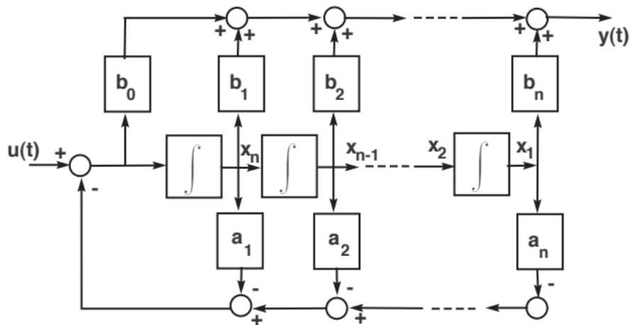
Figura 5: Representación gráfica de la forma canónica controlable.
