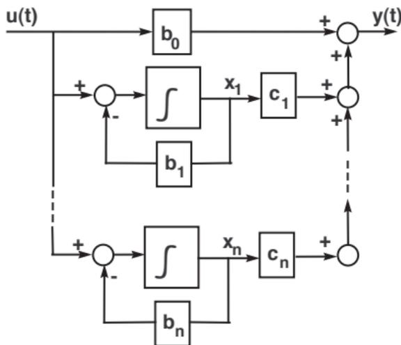
Figura 7: Representación gráfica de la forma canónica de diagonal.
