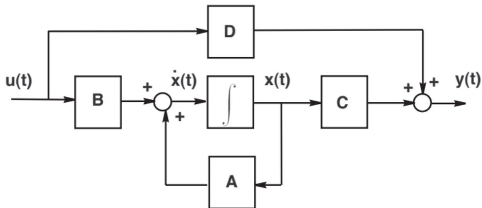
Figura 3: Diagrama de bloques de un sistema en tiempo continuo representado en ecuaciones de estado.
