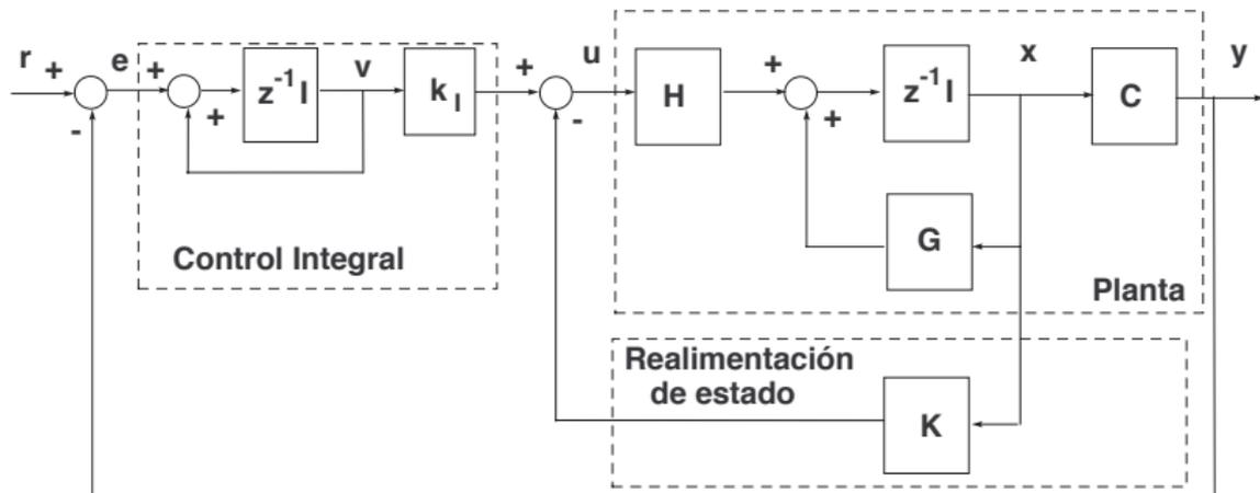
Figura 7: Realimentación de estado con integrador adicional.
