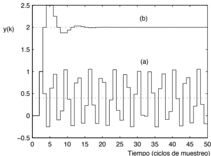
Figura 4: Respuesta del sistema del ejemplo: (a) sin realimentación y (b) sistema realimentado
