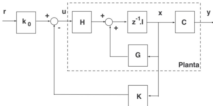
Figura 6: Realimentación de estado con ajuste de ganancia
