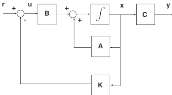
Figura 1: Diagrama de bloques de un sistema realimentado en estado.
