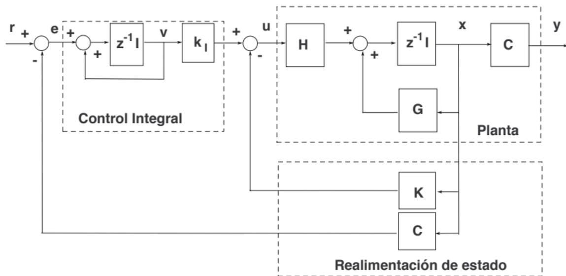
Figura 8: Realimentación de estado con integrador adicional (2).
