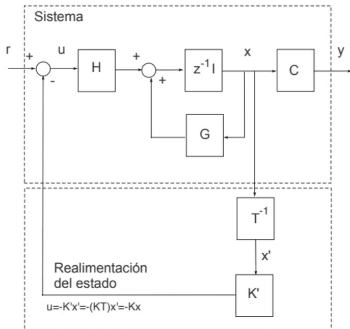
Figura 5: Transformación de un sistema a otra representación de estado para controlarlo.
