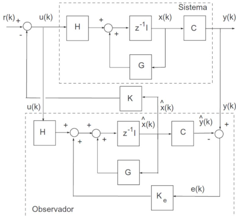
Figura 4: Sistema con observador completo y realimentación del estado.
