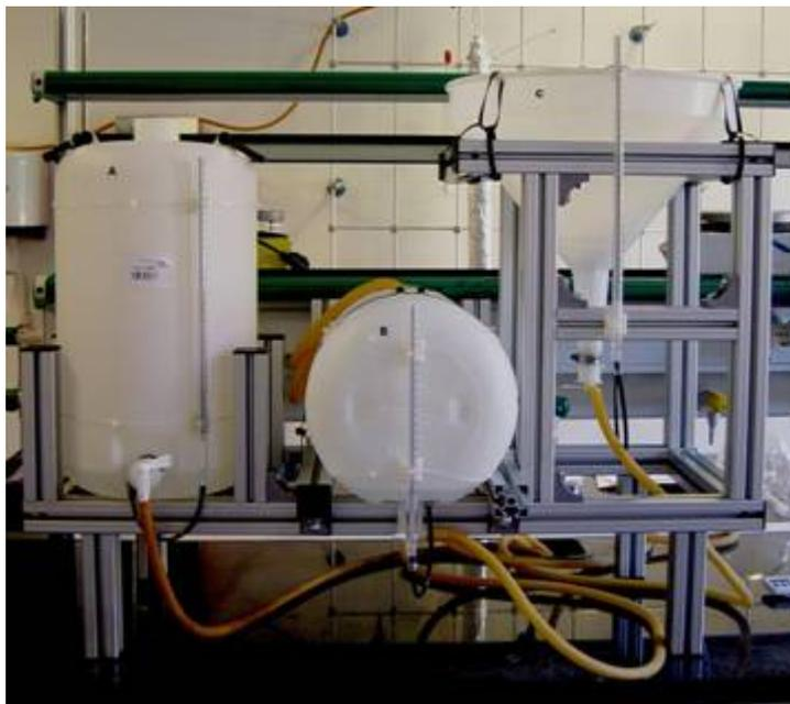
Se plantea el cálculo de la ecuación de velocidad de varios procesos, para lo cual se emplean 3 bidones -A, B y C- de diferente sección. Al producirse el vaciado, la columna de agua del bidón sufre una variación en función del tiempo; dicha variación es inversamente proporcional al área de la superficie del agua dentro del bidón, comportándose como un sistema de
