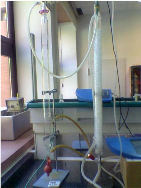
Se empieza a contar el tiempo y medir el pH nada más rellenar la columna con la disolución de NaOH, tomándose valores de pH cada dos minutos, indicando en la tabla la cantidad de CO<sub>2</sub> (expresada en moles) que ha pasado por la columna hasta ese momento. De la posterior representación del pH frente al tiempo se podrá determinar la capacidad de absorción de la columna. Se realizarán medidas del pH hasta que no se observe ninguna variación del mismo en un largo
